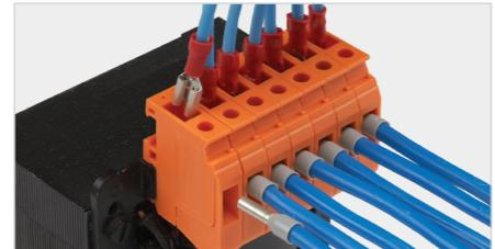
TRV serisi trafo klemensleri Alçak Gerilim trafo imalatında ihtiyaç duyulan tip ve kesiterde kullanıma sunulmuştur. TRV 4 ürün fast-on kablo başlığı ile de kullanıma olanak sağlamaktadır. TRV S sigortalı klemenslerde ise 5x20 mm ölçüsünde cam sigorta kullanılmaktadır. Plotter ile markalamayı kolaylaştıracak aksesuarları mevcuttur.
