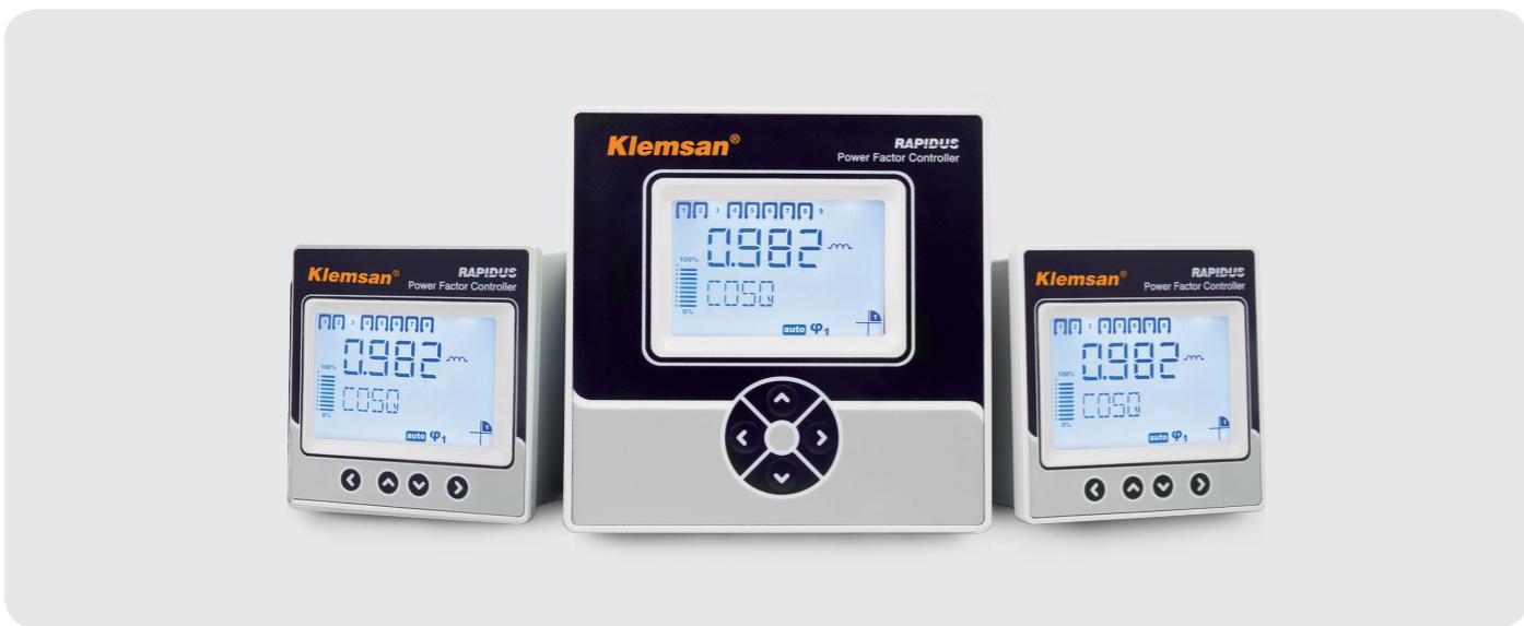
RAPIDUS 1 serisi, çok fonksiyonlu bir fazlı reaktif güç kontrol rölesidir. Bağlı olduğu sistemin aktif ve reaktif güçlerini ölçmektedir. Bu ölçümler sonucunda; kompansasyon panosunda bulunan kondansatörleri devreye alır. Ön panelde bulunan LCD ekran ve 4 adet tuş ile tüm kullanıcı işlemleri kolaylıkla yapılır. RAPIDUS'ta, izole RS485 portu bulunmaktadır. 2 adet alarm rölesi ve daha bir çok özelliği sahiptir.
