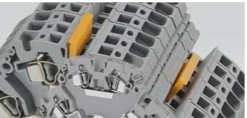
YBK serisi yay baskılı iki katlı ray klemensleri 2,5 - 4 mm<sup>2</sup> kesitleri arasında kullanıma sunulmuştur. Montaj rayı ölçüsünü değiştirmeden bağlantı sayısını iki katına yükselterek avantaj sağlar. Her iki katı ayrı ayrı köprülenebilmektedir. Plotter ile her kesite özel, projelerinize uygun markalaşma çözümleri mevcuttur.
