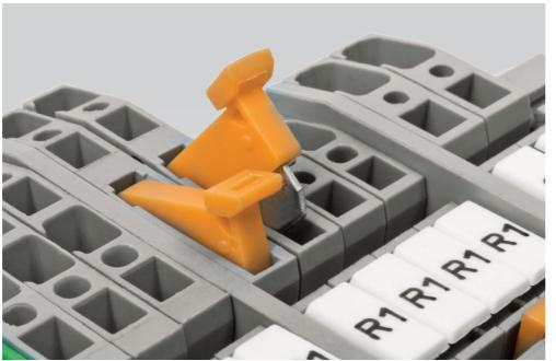
YBK seri ayırma klemensleri bağlı bulundukları devrede enerji altında iken sağlıklı açma - kapama yapabilmek için kullanılmıştır. Tek katlı tüm YBK seri klemenslerle birlikte serit etiket ile markalanabilir ve üst köprü ile koprülenebilirler. Plotter ile her kesite özel, projelerinize uygun markalama çözümleri de mevcuttur.
