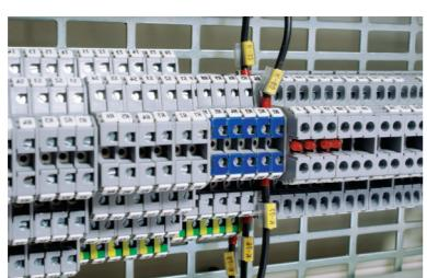
PUK 2T serisi vidalı ray klemensleri aydınlatma ve priz linyelerini içeren kat panolarında, bir linyeye ait faz-nötr-toprak bağlantılarını tek klemenste yapmaya imkan sağlar. Faz ve nötr katları ayrı ayrı köprülenebilir. Topraklama için klemensi raya takmanız yeterlidir. Plotter ile projelerinize uygun markalama çözümleri mevcuttur.
